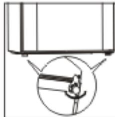
6. Za účelom zaistenia ľahkého otvárania dverí vzdialenosť medzi bočnou stenou spotrebiča (zo strany závesov dverí) a stenou miestnosti má byť **50 mm**
